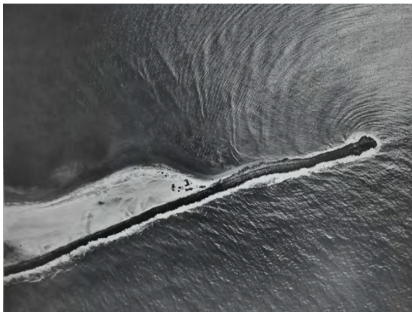
Figura 25. Ponta do Titã, Mocuripe/CE, década de 1940. É perceptível a ação da guia-corrente em relação ao regime das correntezas. É provável que tal fenômeno tenha ocorrido de forma similar no quebra-mar Hawkshaw, de 1874.
