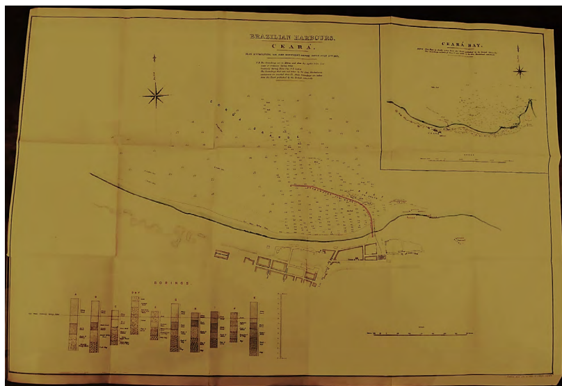
Figura 21. Planta elaborada pelo eng. Hawkshaw para o porto de Fortaleza, 1875. O projeto foi baseado em uma série de análises hidrológicas e geológicas para consubstanciar a organização espacial do sistema.
